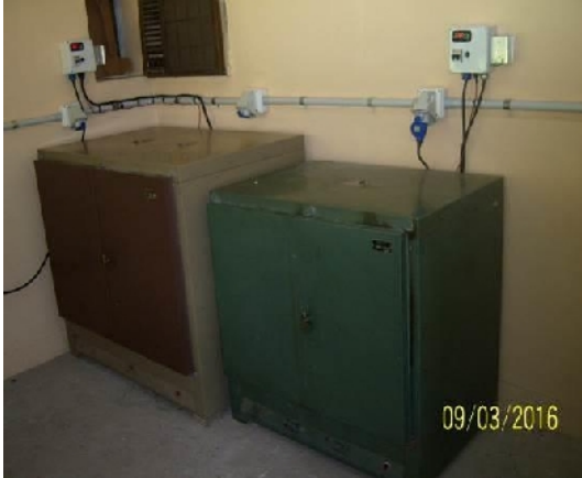
Figura N° 17 - Figura N° 18: Estufas reacondicionadas, con los controladores digitales de precisión.
