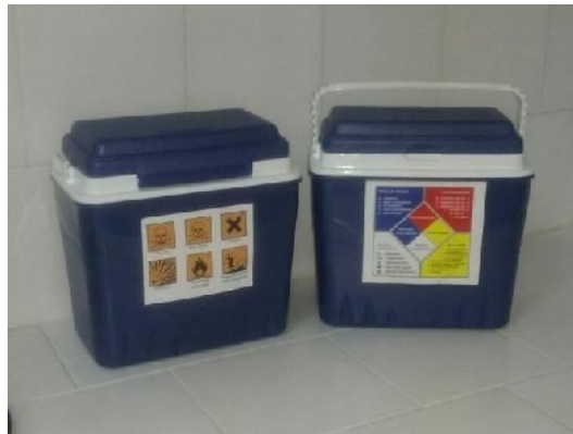
Figura N° 38: Recipientes para traslados de sustancias peligrosas
